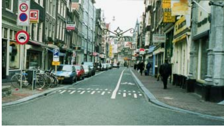
Φωτ. 5.2. Amsterdam. Ολλανδία. Σήμανση δρόμου ήπιας κυκλοφορίας. Όριο ταχύτητας 30 χλμ/ώρα (Ζώνη 30). Διακρίνεται λωρίδα ποδηλάτου και μικρό σαμαράκι που τονίζεται με ειδική οριζόντια σήμανση.
