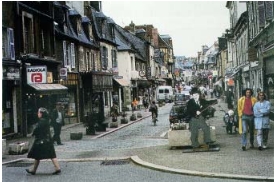
Φωτ. 5.3. Δρόμος ήπιας κυκλοφορίας όπου ο ποδηλάτης κινείται με ασφάλεια. Το πεζοδρόμιο δεν διακόπεται στη διασταύρωση κι έτσι ο δρόμος παίρνει τη μορφή εσωτερικής αυλής. (Η φωτογραφία παραχωρήθηκε από το CETUR και περιλαμβάνεται στην έκδοση Réduire la vitesse en agglomération, σελ. 32).
